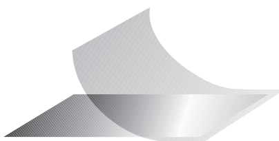
Пластинчатый отпечатанный серебристый ярлык (материал 951А) защищён прозрачным ламинированием (материал 951В).
