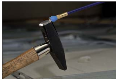
Мощный магнит способен поднять металлический инструмент весом до 2.5 кг.
