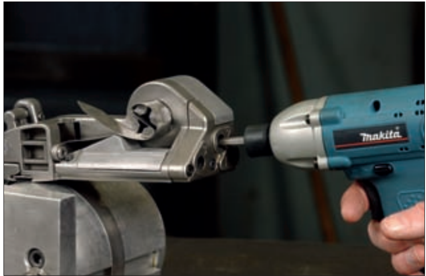
Лёгкая в использовании AMTS значительно ускоряет вязку жёсткими металлическими стяжками.
