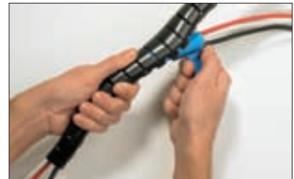
Скользящим движением приспособления для монтажа через кожух Helawrap поместите кабели внутрь.
