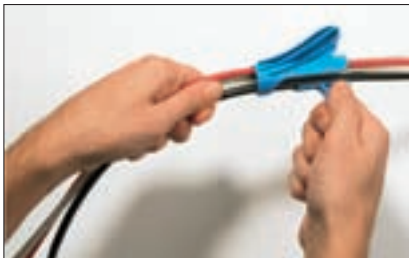
Заправьте один или несколько кабелей через щель в приспособлении для монтажа.
